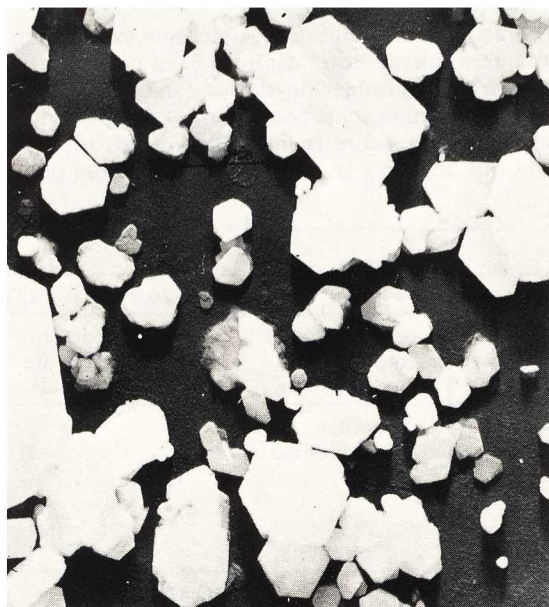
FIGURA 22.8. Fotografía obtenida mediante el microscopio electrónico de cristales de la caolinita, aumentados aproximadamente 20.000 veces (Paul F. Kerr.)
